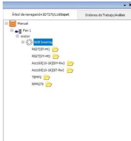
El icono de carpeta situado junto al nivel del sensor significa que aún no contiene ningún dato.
