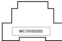
Figure 11-15 : Chaque Module Output possède une adresse MAC unique indiquée sur le flanc du boîtier.
