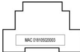
Abbildung 11-15: Jedes Output – Modul verfügt über eine einmalige, auf der Flanke des Gehäuses angegebene MAC – Adresse.
