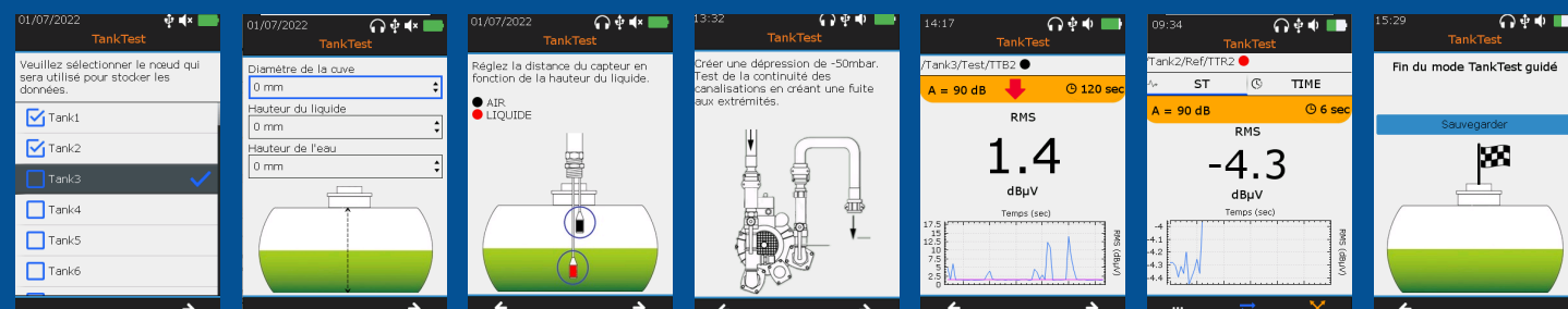
Seleziona il punto nel database | Inserisci le informazioni sul serbatoio | Posiziona i sensori | Crea la depressione con la pompa per il vuoto | Acquisisci i dati dal sensore nero | Acquisisci i dati dal sensore rosso | Salva i dati e crea il tuo report
