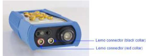
Las conexiones de los sensores externos son conectores LEMO. Se trata de un conector industrial de uso frecuente, conocido por su fiabilidad y robustez. Tienen un cilindro moleteado con carga de resorte y polarización mecánica para conectarse sólo de una forma.
