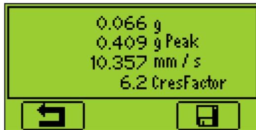
Pulse el botón F1 para volver a la pantalla de mediciones sin guardar los datos.
