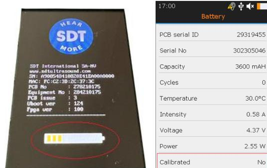
Se è stato identificato un errore di calibrazione della batteria, è necessario caricare completamente la batteria. Per caricare completamente la batteria, procedere come segue:
