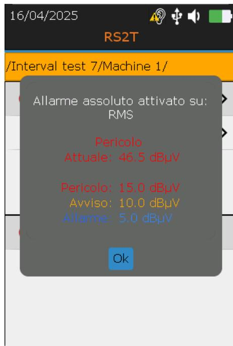
La notifica mostra l'allarme attivato, il livello di attivazione e l'impostazione dell'allarme per il valore attivato in quel punto.
