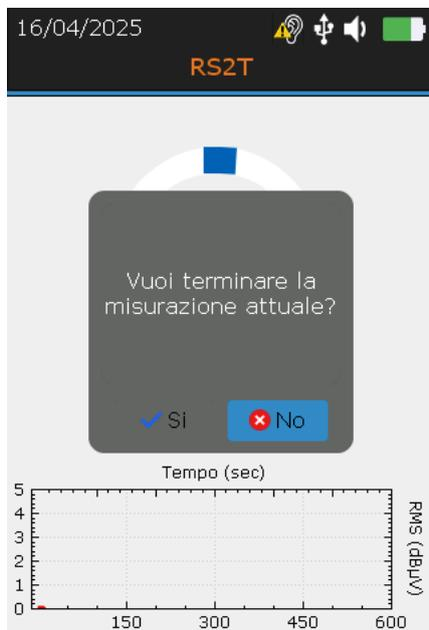
Per interrompere il processo di misurazione, premere ENTER e confermare. Come nel caso di una misura predefinita, il 340 visualizzerà gli indicatori di condizione e, inoltre, la durata della misura raccolta.
