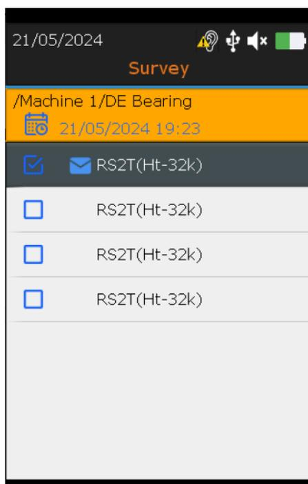
Wenn die Meldung zugewiesen ist, wird ein Umschlagsymbol hinzugefügt, so dass Sie leicht sehen können, wo Sie die Meldung bereits hinzugefügt haben. In diesem Fall wird sie im Vermessungsmodus auf Sensorebene zugewiesen. Die Nachricht wird tatsächlich dem Messpunkt (und allen Messeinstellungen in diesem Knoten) zugewiesen.
